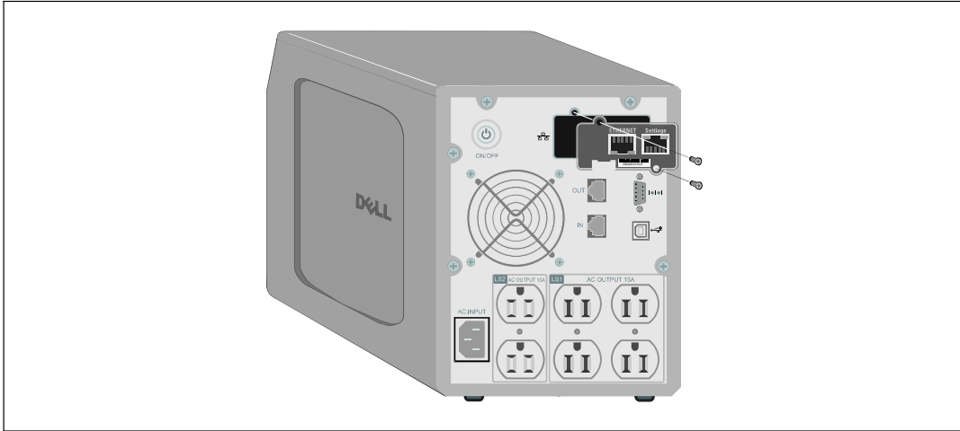
Figura 4. Instalación de la tarjeta
